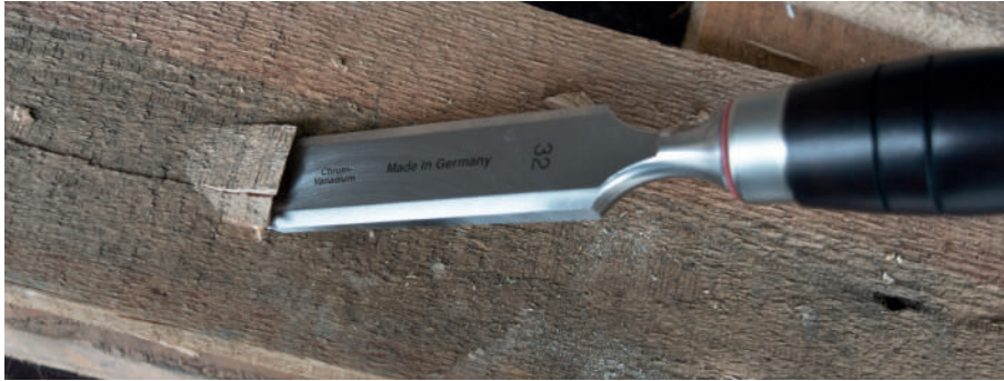
Schrijnwerkersbeitel "type WH800" met houten steel Ciseau de menuisier "type WH800" avec manche en bois
